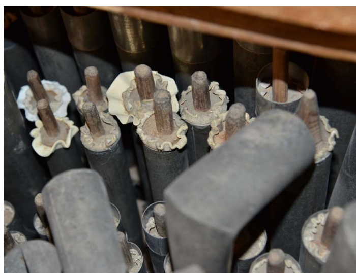
Gedekte Metallpfeifen (Holzstöpsel und Lederdichtung)
